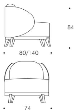
Poltroncina anche in versione dormeuse imbottita con struttura in Rovere tinto Wengè e schienale in compensato curvato rivestito in tessuto o in cuoio. Cuscino schienale in piuma d'oca vergine canalizzata. Seduta in poliuretano espanso a densità variabile. Disponibile in tutti i tessuti in collezione. Cuscino di seduta e schienale sfoderabile. Profilo decorativo in contrasto di colore a rilievo.
